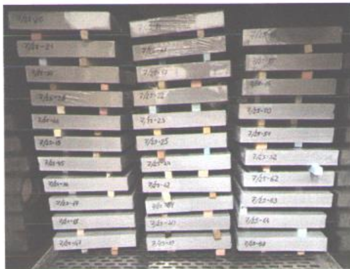
Рисунок 2 – Загальний вигляд дослідних зразків плит теплоізоляційних з екструдованого пінополістиролу (XPS) марки «STYROPLIT» виробництва ТОВ «ЗАВОД «СВІТОНДЕЙЛ» під час кліматичних впливів
